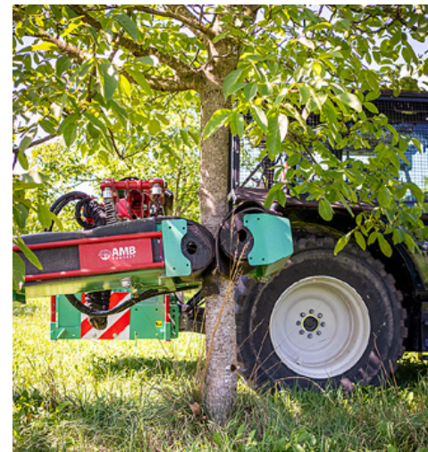
Avec le vibreur d'arbre monté sur l'A134, la récolte est nettement plus facile.
