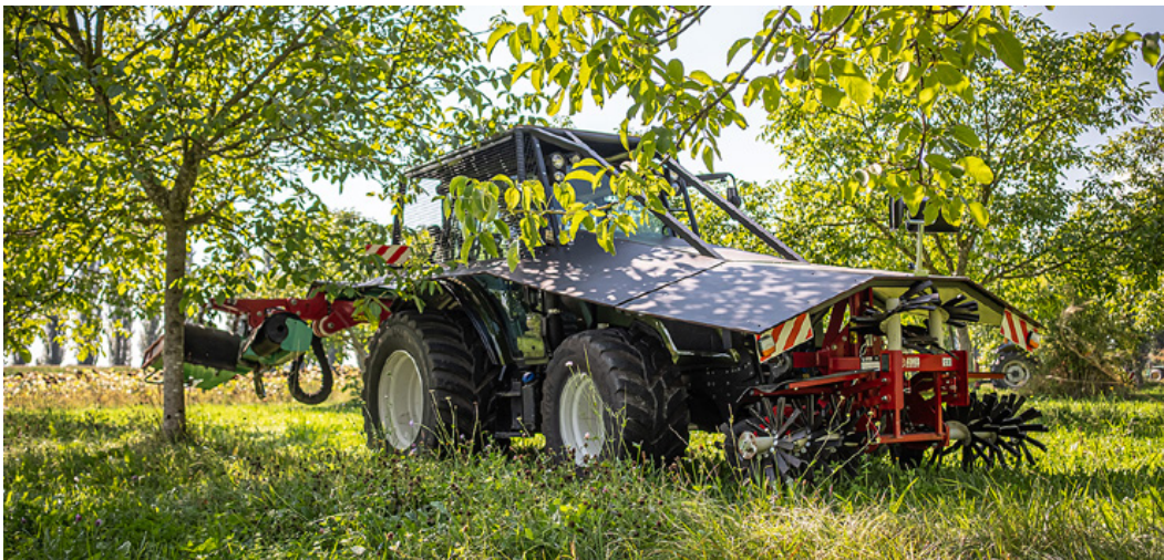
Il ne reste plus grand-chose du tracteur : Pour le protéger des noix qui tombent (et celles-ci des roues), le Valtra A134 a été coffré.
